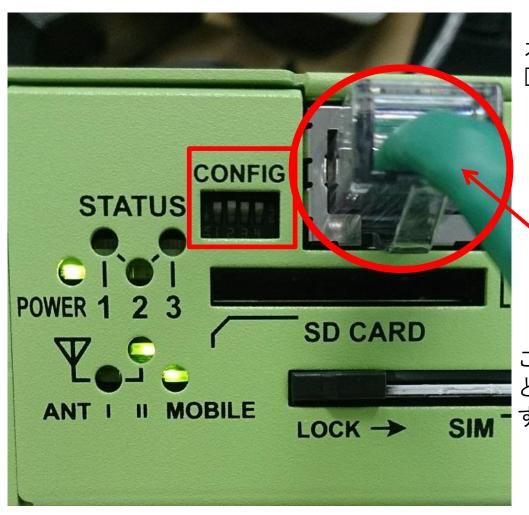
本体の電源をOFFにし、 DipSWの左側2個を下にセットします。
